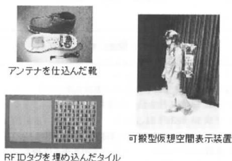
図 4: 二次元位置計測システム
